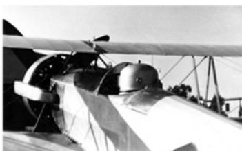
Nel 1934 Mario Pezzi ottiene il record di altezza per motori a pistoni, raggiungendo i 14443 metri con un Caproni 113 biplano dotato di una cella iperbarica con un motore Alfa Romeo da 550 cavalli.
